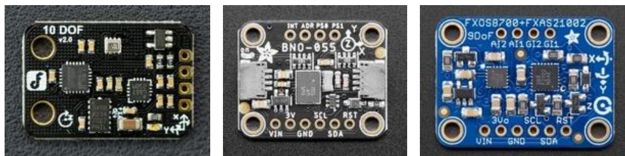
Figure 4.1 Les différentes centrales inertielles testées dans le cadre du projet. À gauche, la centrale inertielle à 10 DDL de DfRobot. Au milieu, la centrale inertielle BNO055 à 9 DDL de Adafruit. À droite, la centrale inertielle Fermion de 9 DDL de Adafruit.
