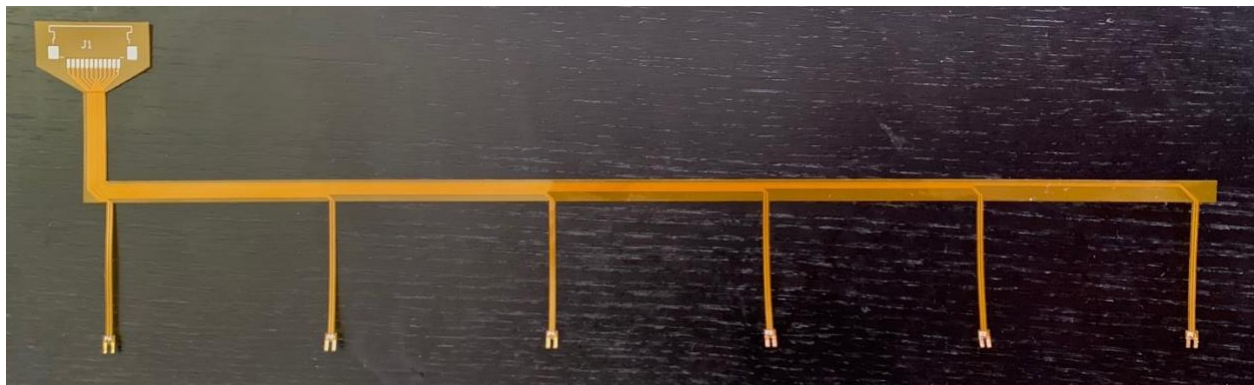
Figure 4.4 PCB flexible avec des jauges suivant une direction unique
