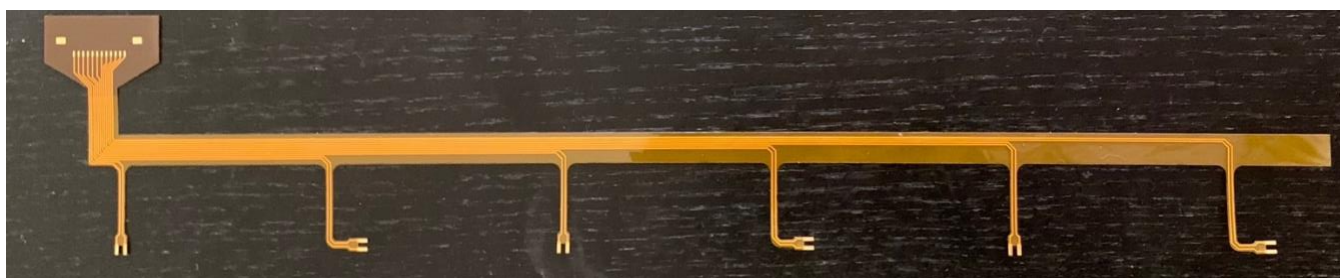
Figure 4.6 PCB flexible avec les jauges suivant deux directions différentes
